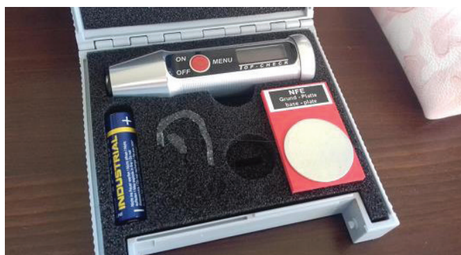
Rys. 1. Tester TOP CHECK do pomiaru grubości warstw anodowanych (fot. A. Piochacz)
